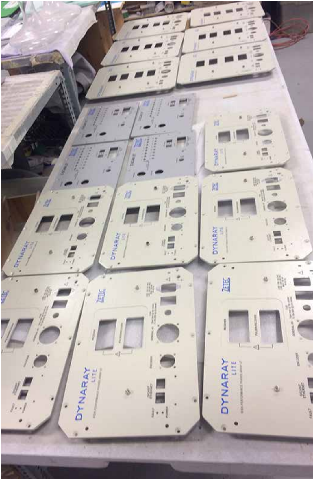
Jet de sable sur panneaux de contrôle
