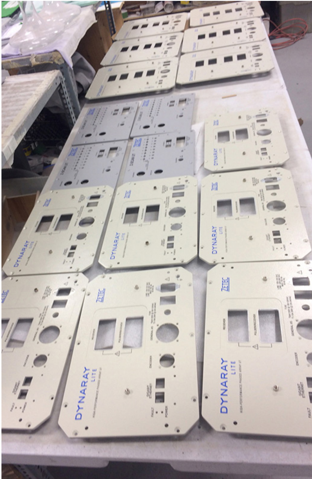
Jet de sable sur panneaux de contrôle
